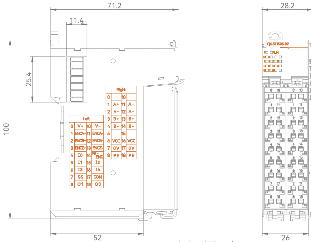
图10 HCQX-ST1505-D2 端子说明 (单位: mm)
