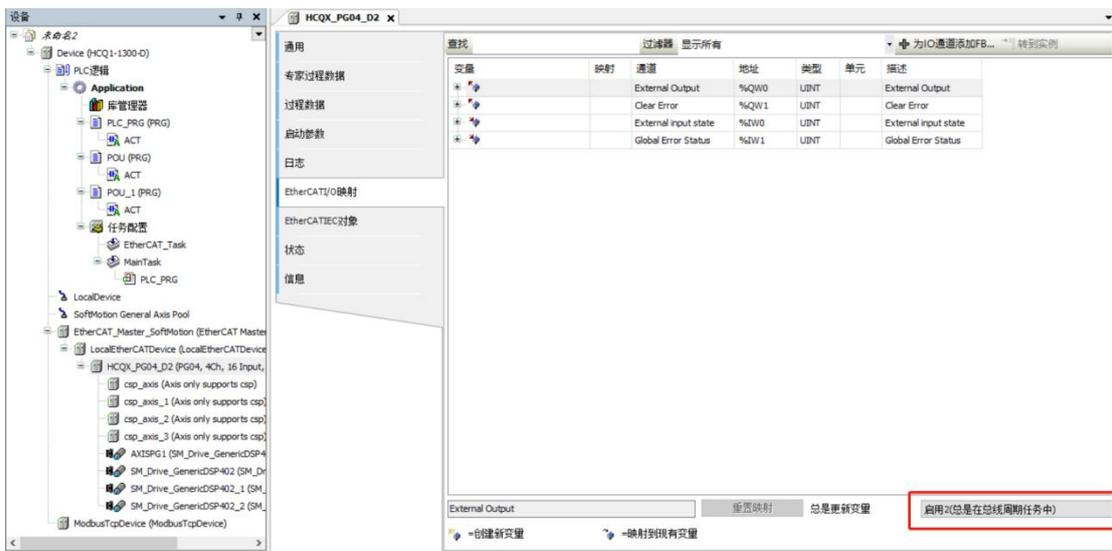
打开 缩放/映射 进行轴参数配置。
