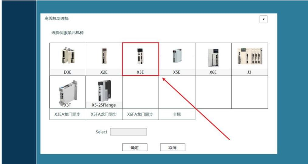
选择对应伺服的类型，如本测试使用 SV-X3EB010A-A2，应选 EB 类型。选择后【Select】显示【X3-EB】后点击【确定】按钮。
