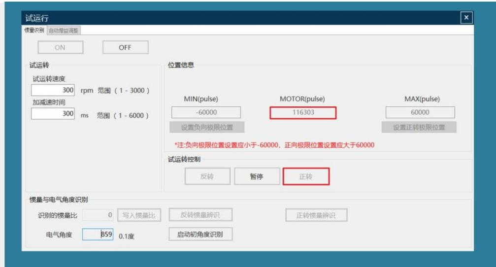
点击【正转】运行停止后，如果再次点击【正转】按钮，界面会显示【试运行请设定极限位置】，说明运行已走到极限位无法继续前进，此时点击【反转】按钮可正常反转。
