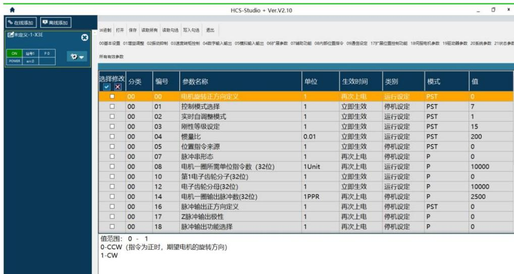
16 进制：点击【16 进制】按钮，可使用 16 进制格式写入参数值。设定后需要先点击【确定】按钮再点击【键入】按钮进行参数写入。
