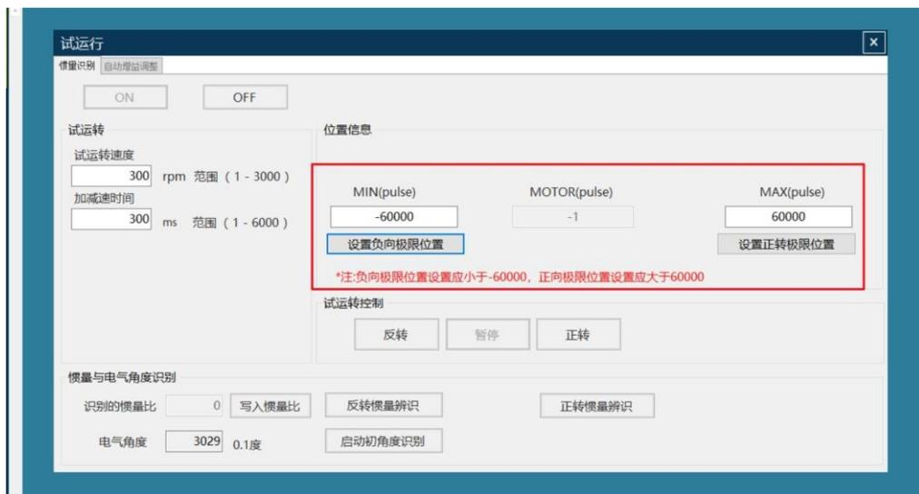
点击【正转】按钮电机正向运行，【MOTOR（pulse）】显示电机位置，单位为电机分辨率。（如 17 位电机电机分辨率为 131072，电机正向转动一圈【MOTOR（pulse）】增大 131072。）运行中可点击【暂停】按钮让电机停止运行。
