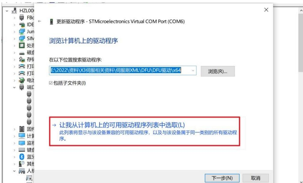
4) 取消勾选【显示兼容硬件】，在【厂商】下找到【STMicroelectronics.】，【型号】选择【STMicroelectronics Virtual COM
