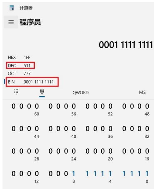
**故障 DO 状态:** 发生当前报警时伺服驱动器的 DO 状态，数值为 10 进制，需转换为 2 进制后，从右向左分别代表 DO1 到 DO5 的状态，0 代表有输出信号，1 代表无输出信号。
