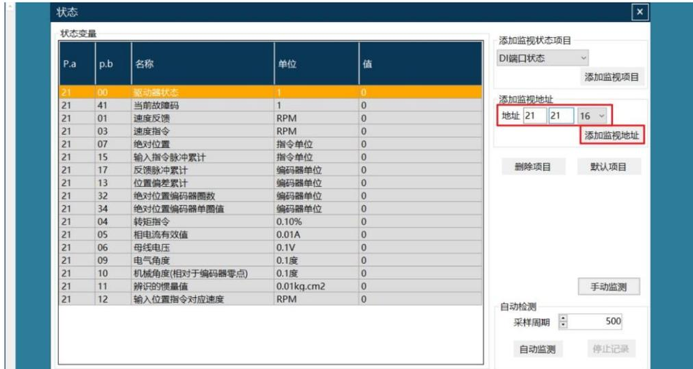
点击【自动监测】按钮开始监测状态变量，参数值会按照设定的采样周期进行实时更新。点击【停止记录】按钮进行停止监测。
