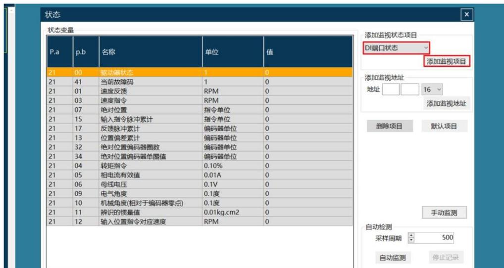
在【添加监视地址】框中可手动输入参数地址进行监控，如下图中为添加 P21.21 监视 DI 端口状态，对应参数大小选择是 16 位参数还是 32 位参数（32 位参数在参数列表中会有备注），选择后点击【添加监视地址】按钮进行添加。
