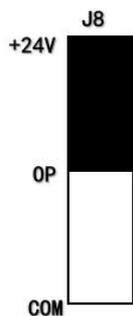
图 1. J8 跳线跳帽插接在 24V 端示意图
