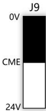
图 10. J9 跳线跳帽插接在 24V 端示意图
