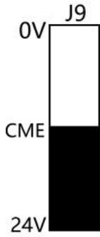
图 8. J9 跳线跳帽插接在 24V 端示意图
