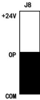
图 4. J8 跳线跳帽插接在 COM 端示意图
