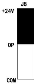
图3 J8跳线跳帽插接在24V端示意图
