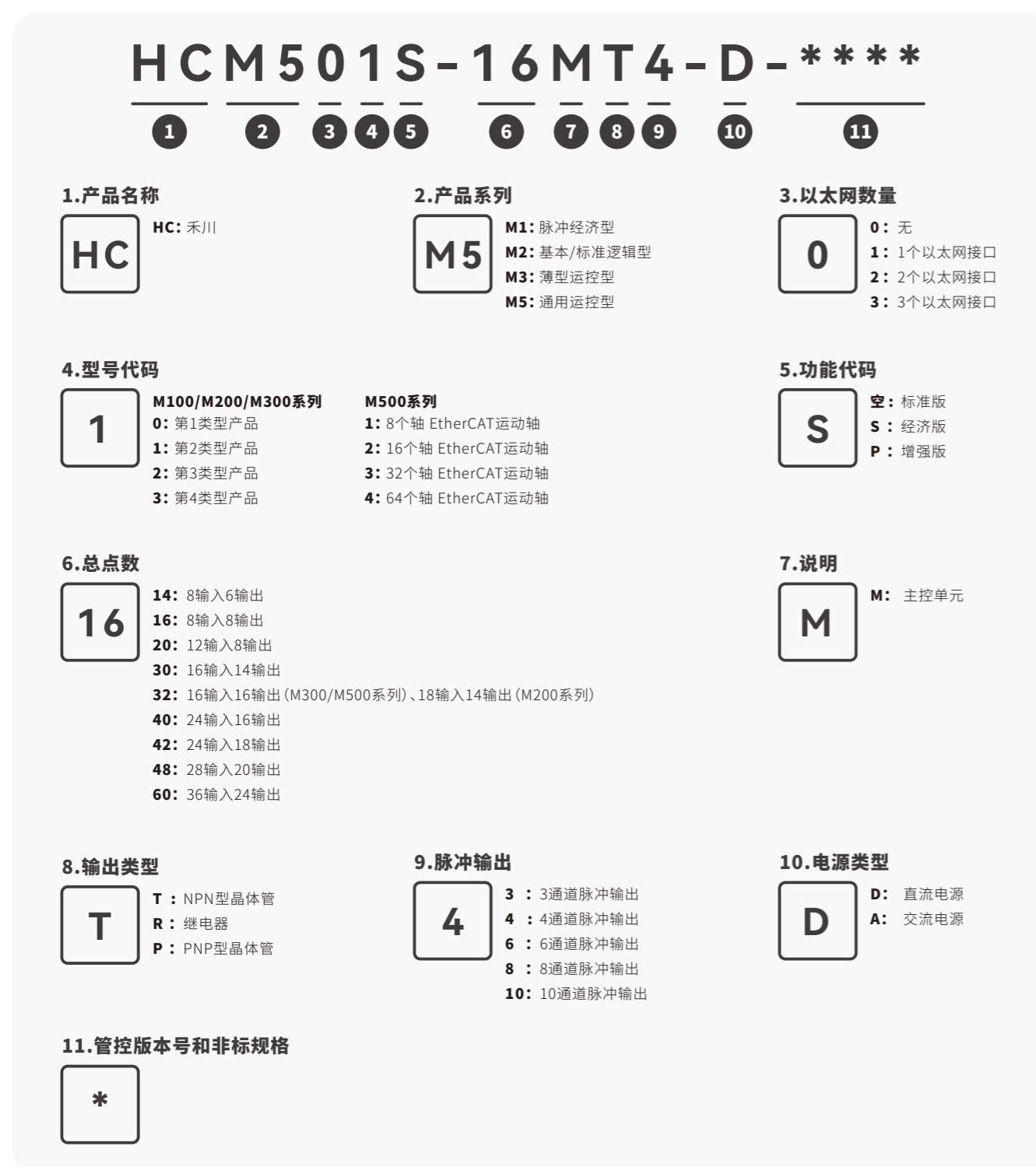
注：1.型号代码中“第×类型产品”间主要是功能区别； 2.型号代码中的EtherCAT运动轴为最大轴数限制。
