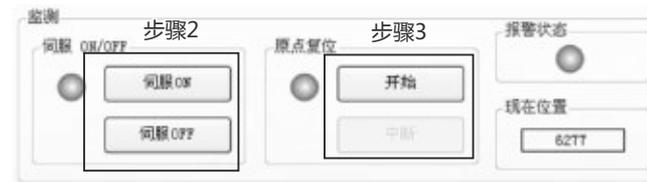
图8.9.17 原点复位的操作方法 2 ( HCX-SETUP )
