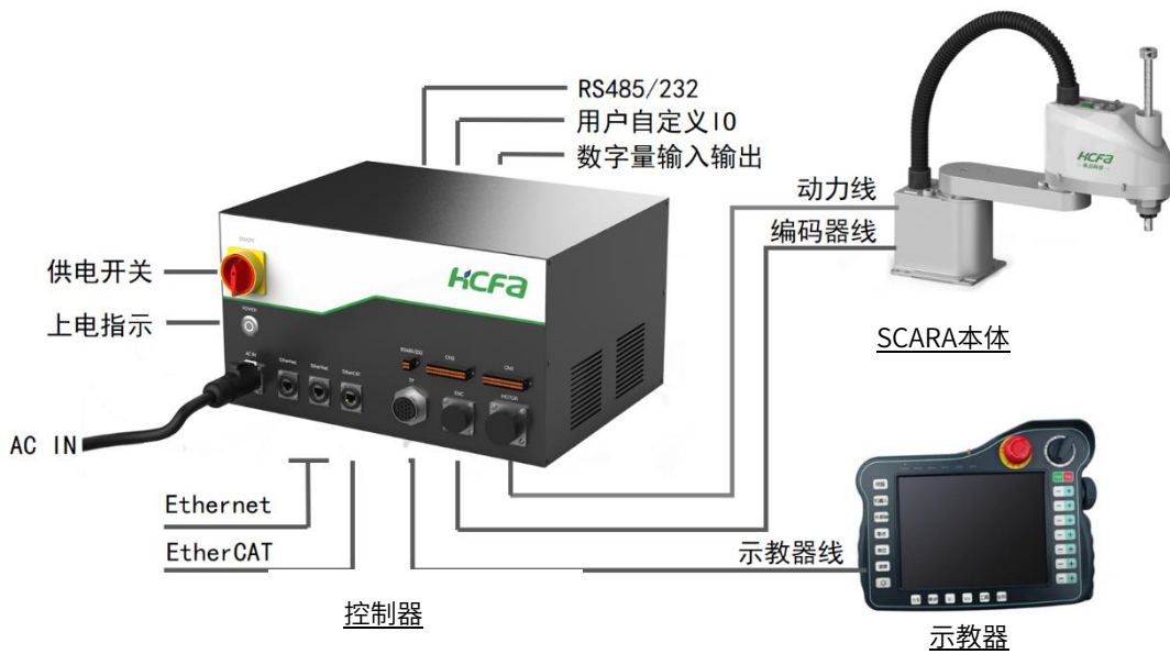
图5-1 控制器与本体接线示意图
