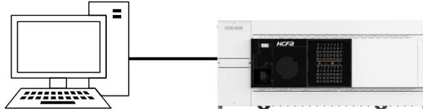
通过产品自带的 USB 电缆或者询问我司意见通过的电缆进行连接。
