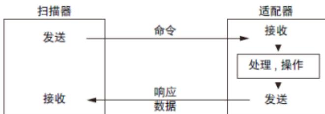
根据服务数据通讯发送命名格式，通常需要指定 Service code、Class ID、Instance、Attribute ID、Service data。在应用程序中可以通过 EtherNet/IP 服务功能块库 EtherNetIPService 来实现，如下图库管理器中所示：
