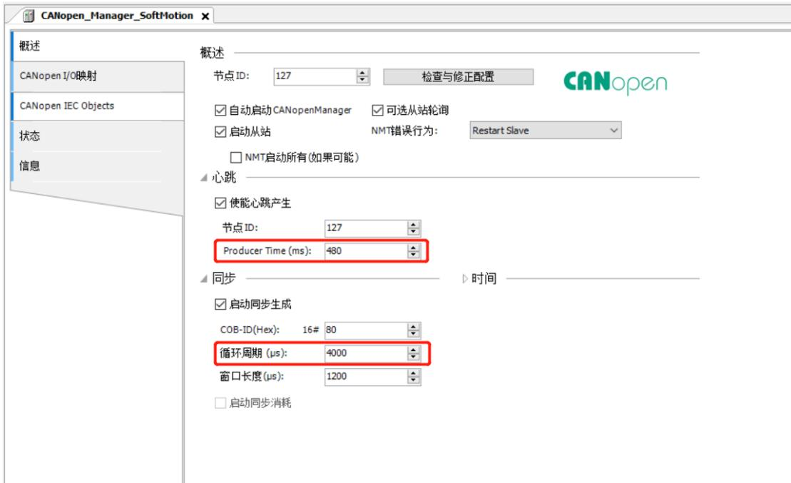
带轴如果较多，总线负载过高情况下，可以加大**循环周期**。**Producer Time**为心跳生产时间，必须为**循环周期**的倍数，如修改**循环周期**后需要同步修改
