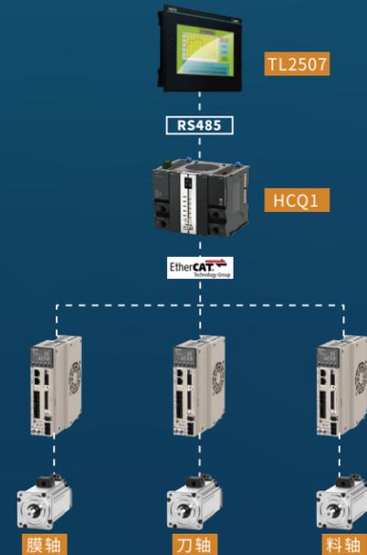
**控制器:** HCQ1高性能PAC, 基于PLCopen的运动控制规范, 模块化编程方式, 支持IEC61131-3规范6种编程语言; 支持EtherCAT/CANopen/Modbus TCP/Modbus RTU通讯协议; 支持电子凸轮/电子齿轮/飞剪/追剪等运动控制功能。
